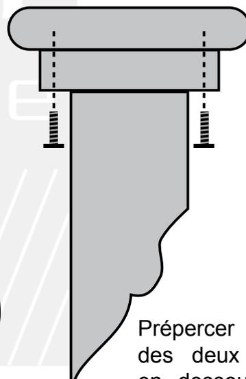
Prépercer la filante des deux côtés par en dessous tous les mètres avec la mèche avec fraise et fixer avec une vis inox 40/4,5
