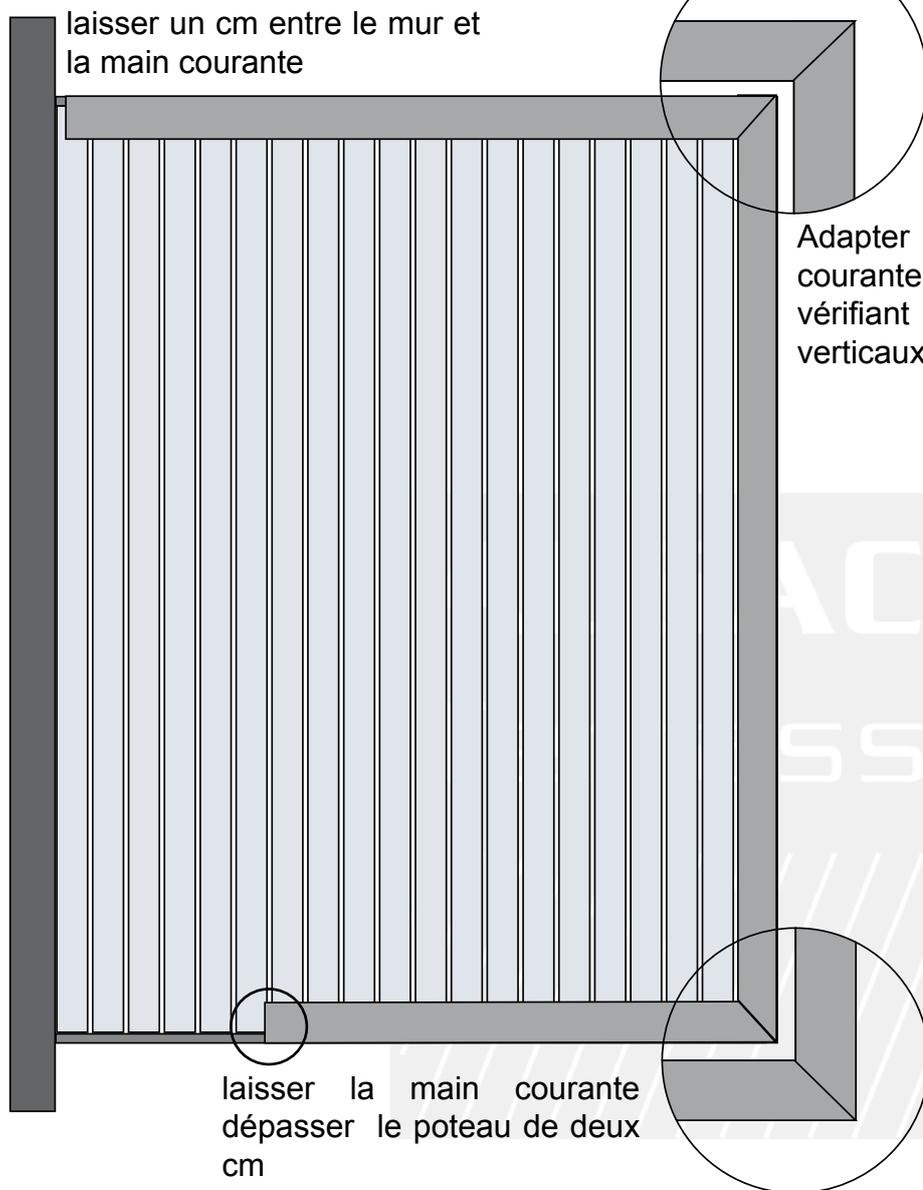
Adapter la main courante à l'angle en vérifiant les niveaux verticaux des poteaux
