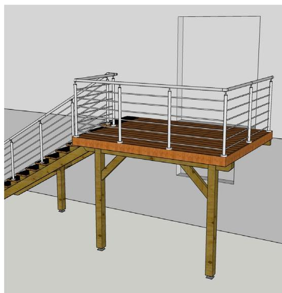
Exemple d'un palier de sortie en bois exotique avec garde-corps inox
